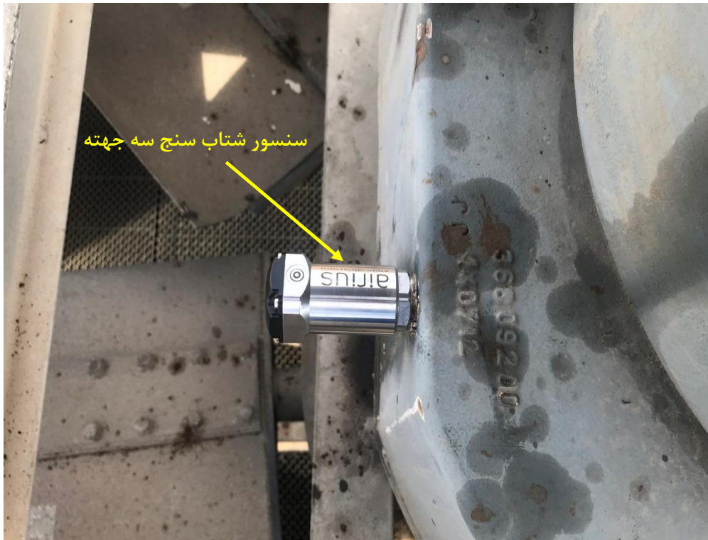
تصویر شماره 4- سنسور سه جهته نصب شده بر روی گیربکس
